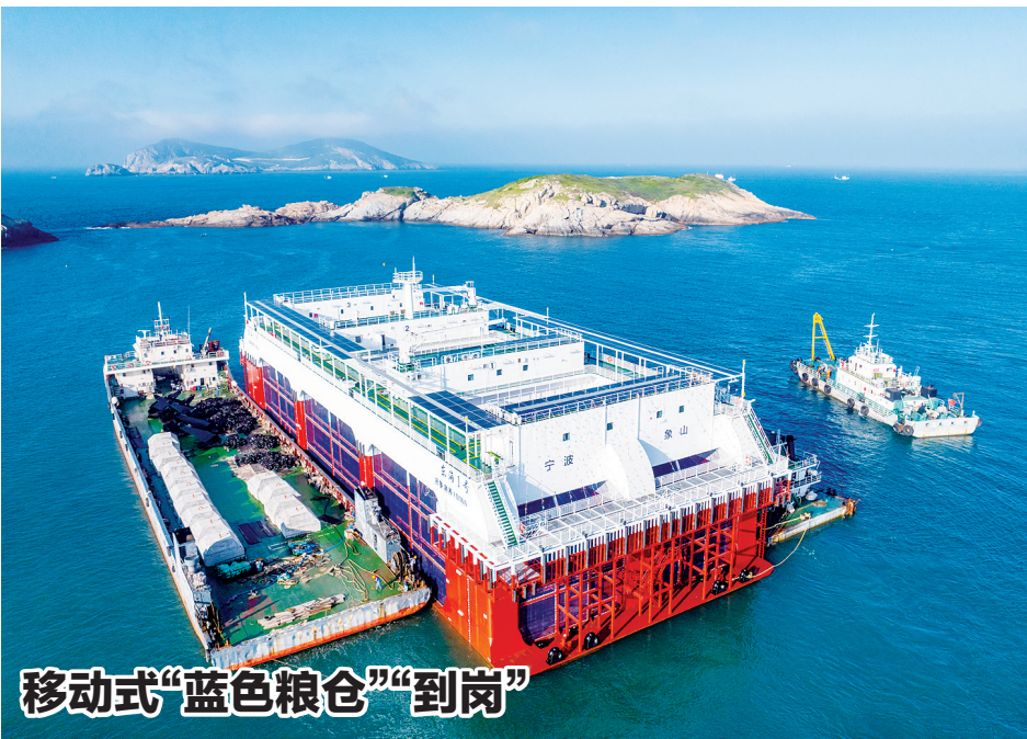
近日,我省首座深远海半潜式养殖平台顺利拖至象山外海海域,工人们随即对平台进行固定安装,开展海上下沉和上浮试验。该平台长82米、宽32米,高度相当于7层楼房,作业深度13至15米。预计可年产优质海产品90万尾,产值约4000万元。
